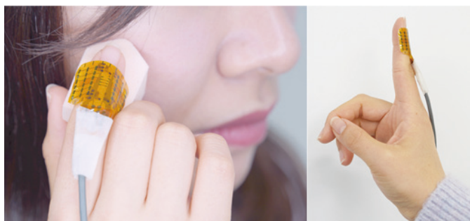
図7 新規開発中の力覚+モーショセンサ
