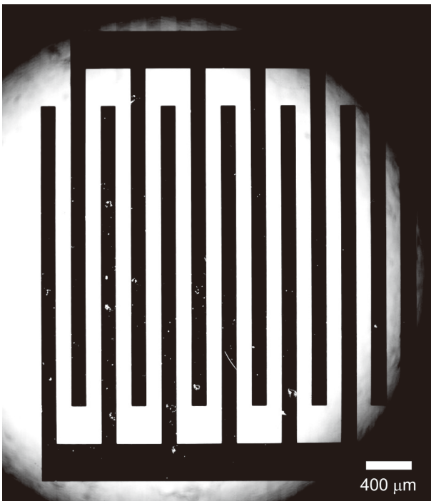
図 4 作成した IDT 電極の顕微鏡写真。
